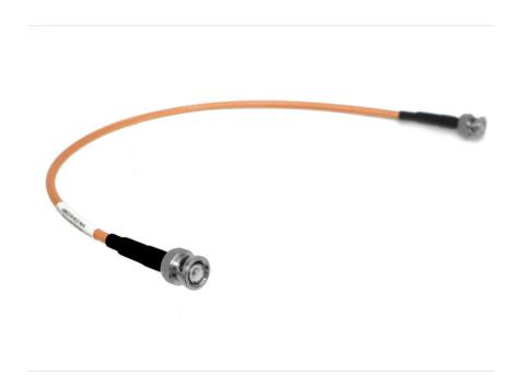
射频电缆泄露损耗: 泄漏损耗是信号根据电缆屏蔽的编织间隙辐射出去的信号。它一样导致信号在传输过程中的能量损失。它是高频传输中不可忽略的问题。因此,电缆的编织覆盖率不可以过低。总之,同轴电缆对信号的传输损耗具备各种要素。它的末尾损失基于上述各种损失的总和,可以使用网络分析仪测试这种类型的综合损失。电缆的直流电阻只在低频时才在信号衰减中起主要作用。在高频下,信号衰减主要取决于集肤效应和介电损耗。随着同轴电缆频率的增加,信号衰减呈指数增加。因此,电缆的传输损耗对于考虑高频损耗很重要。除了电缆的设计,生产和加工之外,使用过程中不正确的构造也将对电缆的正常使用产生重大影响。同轴射频电缆的每单位长度的损耗是lq(D/d)的函数,也就是说和电缆的特性阻抗有关。长沙超柔电缆
