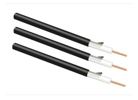
射频电缆阻损耗: 电阻损耗是电缆所具备的直流电阻和导体高频感应所造成的涡流对信号能量的消耗。电阻值的大小与电缆采用的原材料和生产工艺相关。同时它会随传输频率的改变而发生变化,缘故是导体在传输交流信号中,具备趋肤效应。随之频率的增加,有效电阻会不断加大。当交流电流通过导体时,会在导体周边产生交变磁场。该磁场又会使导体内部生成新的感应电流(涡流),该电流的方向。它与导体中心的信号电流方向相反。与导体表面的信号电流方向相同。那样,导体内部的信号电流被反向涡流抵消,电流减小;导体表面的信号电流与同向涡流一样,电流增大。这就是交流通过导体的趋肤现象。随之信号频率的增高,感应电流扩大,这类状况就越加明显。它使电流只集中在表层很小的截面流动,导致导体的有效电阻明显增加。信号的趋肤深度与频率和材料相关,频率越低,趋肤深度越深;频率越高,趋肤深度越浅。铁比铜的趋肤深度小很多。
